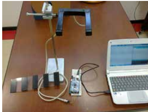
Figura N° 1: Sensor, Compuesto por la Cebra (cuerpo regular con zonas opacas y transparentes), la Compuerta óptica, y Laboduino conectado a la PC
